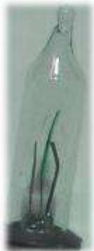
La bombilla encargada de hacer la serie intermitente tiene un interruptor interno que se desconecta con el calor generado por su propio filamento, es una lámina bimetálica que se dobla con el calor. Por lo general son bombillas completamente transparentes.
