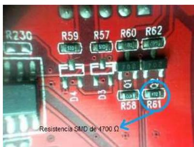
El primer dígito que es el cuatro, el segundo es el 7, lo que nos da la primera lectura para el valor de la resistencia 47. A ese valor se le agregan la cantidad de ceros que se indica en el tercer dígito, en este caso se agregan dos ceros por ser 2 el tercer valor que aparece impreso. Esto nos da un resultado de  $4700\Omega$  o  $4,7\text{K}\Omega$  de resistencia.
