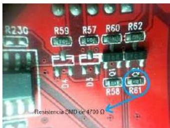
**La tecnología de componentes de montaje en superficie (SMT)** abre un gran espacio a la miniaturización en la fabricación de circuitos electrónicos muy importantes en
