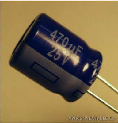
Foto de un capacitor electrolítico en el que podemos observar claramente el valor de capacidad y la tensión máxima de trabajo. Para valores mayores de 1µF (como por ejemplo con los electrolíticos de aluminio o de tantalio) generalmente escriben el valor en el cuerpo seguido por la abreviación de microfarad (µF). Para valores por debajo de 1 µF (1 microfarad) el tema es menos claro. Generalmente se usa una codificación que consiste en un número de tres dígitos seguido por una letra.
