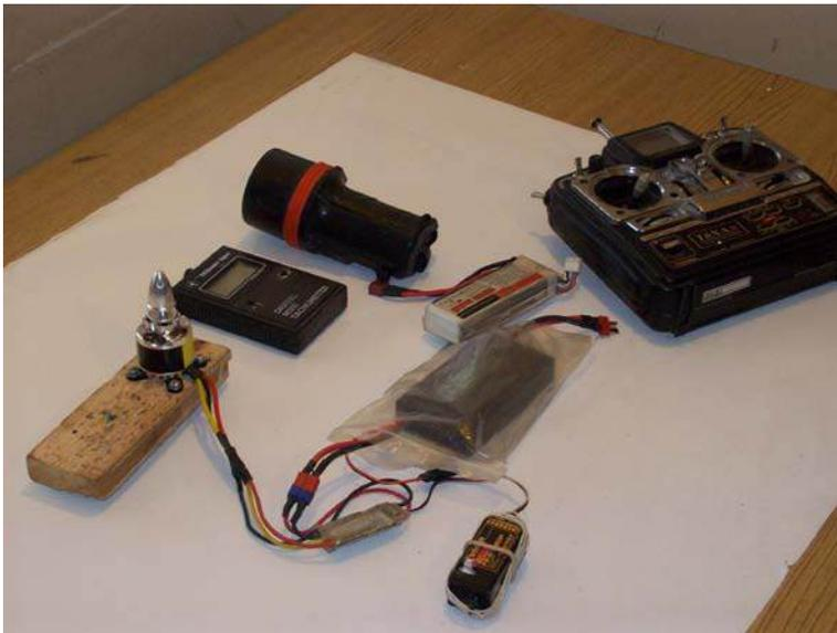
Se enciende el motor y se acelera a fondo. Hay que verificar el amperímetro desde que se conecte la batería. Y que no marque un consumo alto de amperes.
