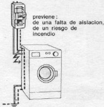
previene: de una falta de aislación, de un riesgo de incendio
