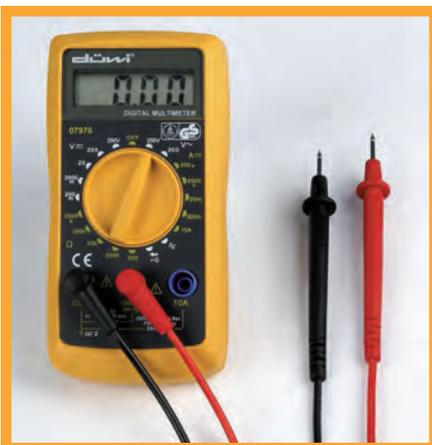
**Multitester.** Conocido también como ohmímetro, multímetro o voltímetro. Dependiendo del uso que se le dé, tiene varias escalas de medición. Aquí solo explicaremos la función y utilidad básica que nos ayude a determinar alguna falla en el circuito eléctrico.
