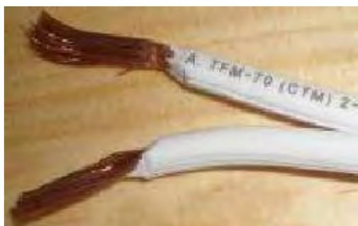
**Cordones y cables flexibles.** Por sus características técnicas son apropiados para instalaciones en áreas no peligrosas, como conductores para los aparatos domésticos fijos, lámpara colgante o fija. Por lo general, se usan en instalaciones eléctricas visibles, en lugares secos. El calibre no debe ser inferior al N° 16 AWG.
