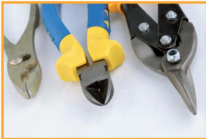
**Alicates.** Los de mayor utilidad en las labores de un técnico electricista son: alicate universal, alicate de punta y alicate de corte. Estas herramientas se usan para cortar, sujetar e incluso pelar cables. Se les debe coger de los mangos asilados. Para asegurar un mejor aislamiento, colocar cinta aislante.
