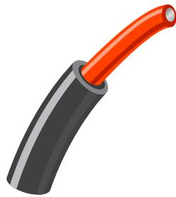
**GRÁFICO 32.** El aislamiento funciona como un medio de seguridad para proteger el conductor y para que ningún elemento extraño o ser vivo entre en contacto y sufra daños irreparables.
