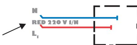
**GRÁFICO 39.** Se observa que los cables de la red van directamente a la caja de derivación.
